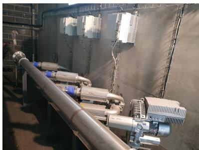
CQM proposait déjà une solution permettant d'étalonner des débitmètres d'air de 40g/s à 800g/s avec des niveaux de précisions =3%.
